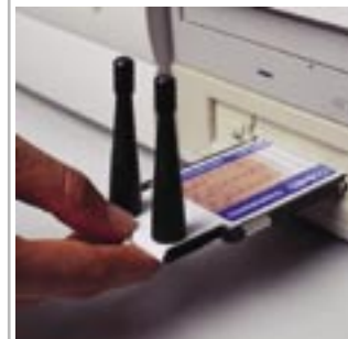
L'ECG 12 voies est construit autour d'une carte PCMCIA qui peut à tout moment être remise à jour.
